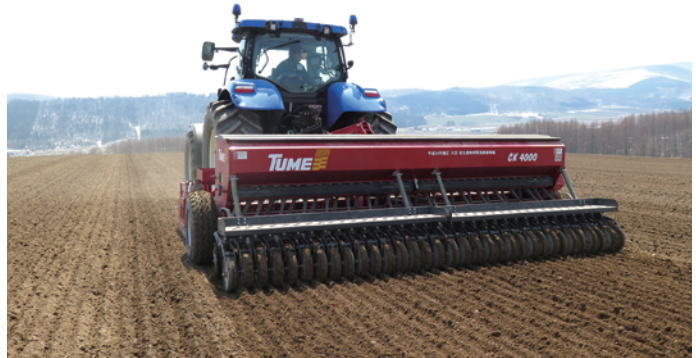
RTK-GPSガイダンスにより真っ直ぐ播種される春まき小麦
