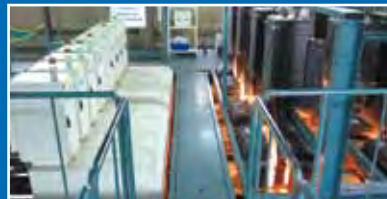
7 カメラによる規格判別と、 空洞センサーによる 判別・除去
