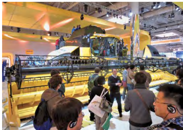
▲刈り取り部分が12.5mある大型のコンバイン
