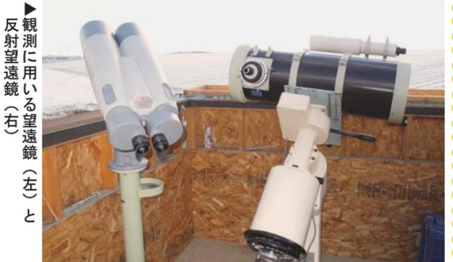
▶ 観測に用いる望遠鏡(左)と反射望遠鏡(右)
