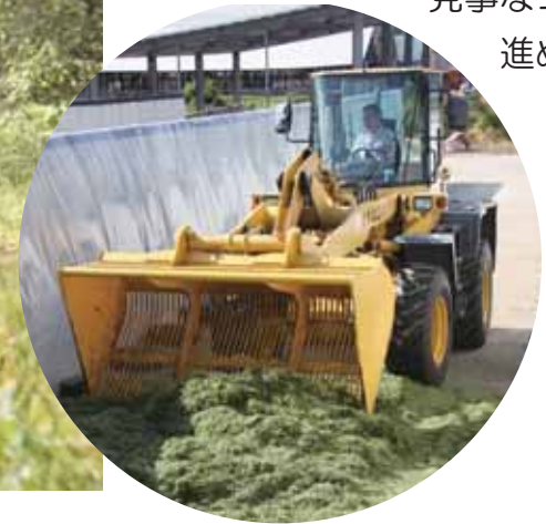
【写真は6月27日、北見地区・豊地の大森泰正さんの採草地で撮影。大森さんの採草地は25㍏。大森さんも構成員の一員でもある「合同会社クロップ」が所有する大型ハーベスターで収穫と裁断し、バンガーサイロに運搬。良好な発酵を促すため、タイヤショベルでいねいに鎮圧した後、シートで被って密封します】
