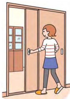
▲引き戸は大開口でも開閉しやすく、つえや車いすでの移動も楽
